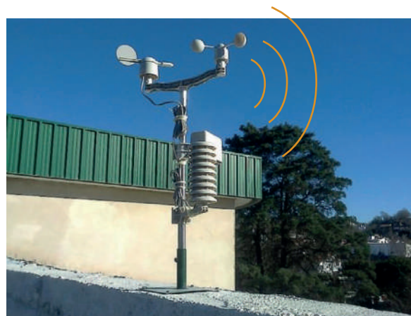
Figura 26: Estación hidrometeorológica instalada en el Instituto Dante Alighieri. El costo de dicha estación es equivalente al de una tableta digital.
